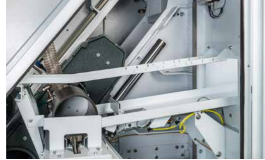
Benzersiz vatka masura besleme cihazı hızlı vatka değişimlerine olanak sağlar.
