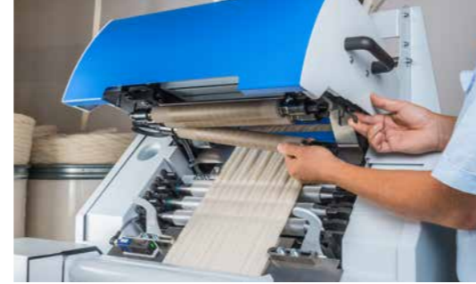
Mükemmel çekim için patentli rulman çözümü ile donatılmış 3 üzeri 3 çekim ünitesi.
