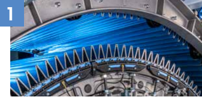
38 aktif çalışan şapka ile genişletilmiş hareketli şapka sistemi
