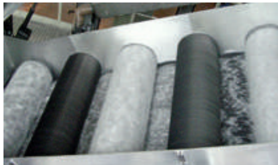
Hohe Wirrlage durch optimale Anordnung der Walzen
