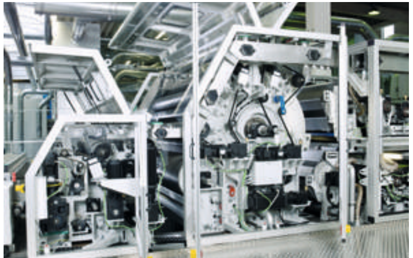
Clean Card Concept: Innerhalb kürzester Zeit sind alle Wartungspunkte der Krempel perfekt zugänglich.
