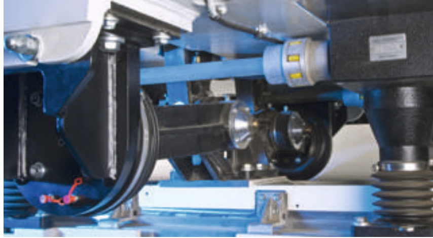
Patentierte, verschleißfreie Schwenklager reduzieren den Wartungsaufwand und damit die Betriebskosten.
