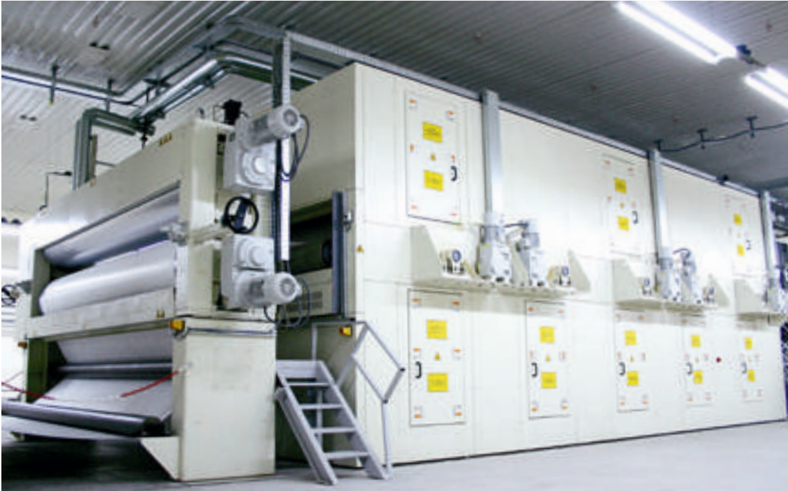
Glättwerk und Reihentrockner für Dachbahenträgervlies
