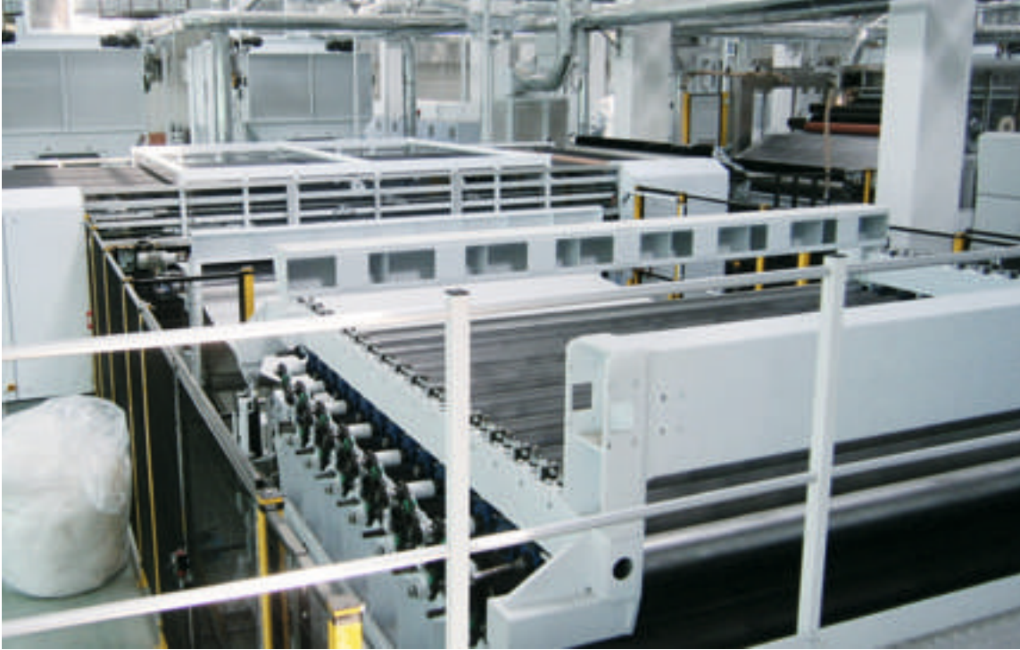
Hochleistungskreuzleger mit Vliesstrecke
