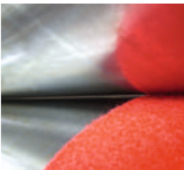
Gleichmäßiger Liniendruck, verbunden mit einer exakt gleichen Spaltbreite, sorgt für optimale Ergebnisse.
