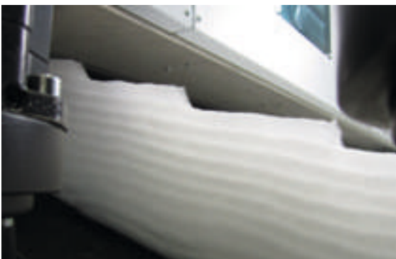
Exakt übereinander liegende Kanten der Vlieslagen bedeuten weniger Kantenschnitt und damit höchstmögliche Materialausnutzung.
