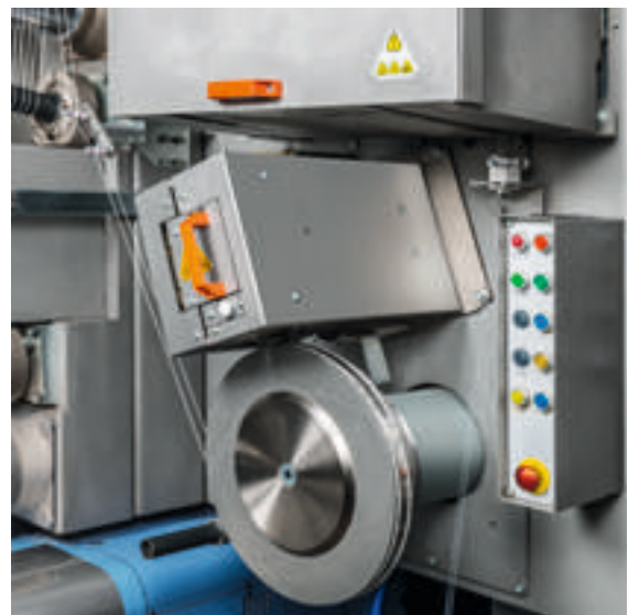
Das Herzstück einer BCF-Spinnerei: HPC Texturierdüse und Kühltrommel
